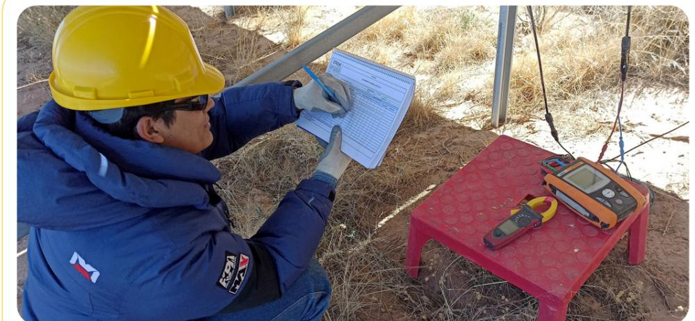
Medición de curvas IV a los paneles solares.
