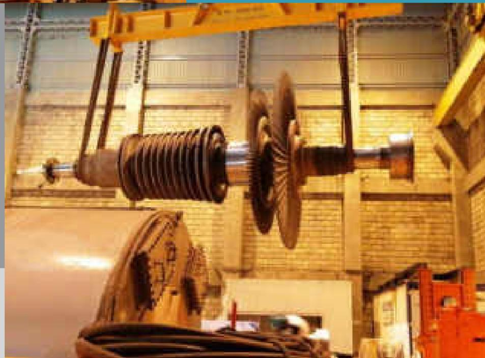
Instalación de rotor de generador en torno transportable
