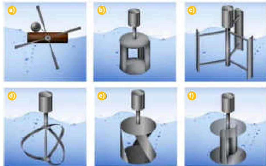
TURBINAS DE FLUJO AXIAL: A) EJE INCLINADO; B) AMARRE RÍGIDO; C) GENERADOR NO SUMERGIDO; D) GENERADOR SUMERGIDO. TURBINAS DE FLUJO CRUZADO: A) EJE HORIZONTAL; B) JAULA DE ARDILLA DARRIEUS; C) H-DARRIEUS; D) DARRIEUS; E) GORLOV; F) SAVONIUS
