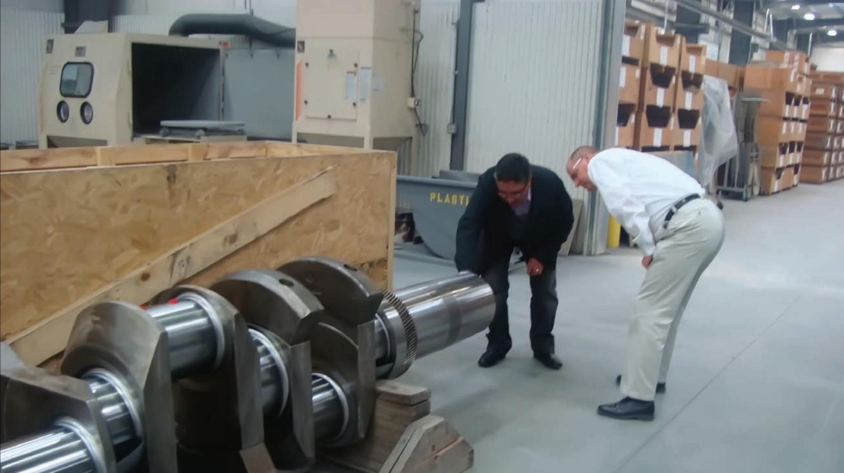
Inspección de cigüeñal para motor Nordberg en los talleres de Exline Inc. en Salinas – Kansas -USA.
