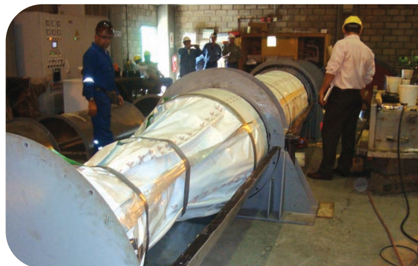
Embalaje al vacío - Rotor reparado Unidad GCH-12
