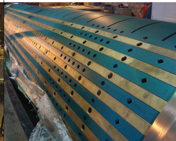
Rotor reparado Unidad GCH-12
